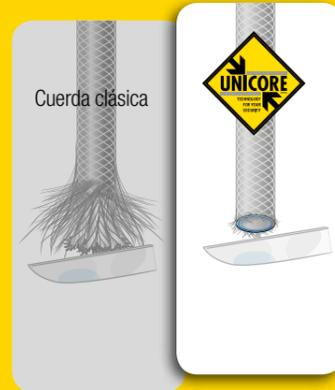
Permite cortar provisionalmente tramos de cuerda con un cuchillo, sin fundir las puntas, sin que la funda se destreñe.
